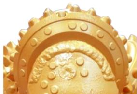
在外排齿与背锥齿之间镶装楔形齿，可保护牙轮壳体的同时修整井壁凸起提高钻头保径能力。
