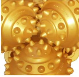
在牙轮主切削齿或外排齿间镶装副齿，能有效保护牙轮壳体延缓磨损，提高钻头在研磨性地层使用寿命。
