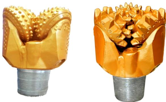
SHA 系列钻头采用滑动轴承 O 形橡胶密封，在常规转速下使用可承受较高的钻压，配合不同的切削结构，可以适应极软到中硬地层。
