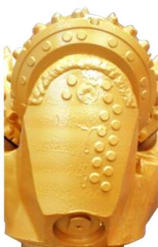
钻头掌背镶齿强化，在研磨性地层或定向井和水平井中，它能有效降低牙掌磨损，提高钻头的保径性能，延长钻头的使用寿命。
