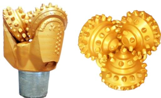
SHA 系列钻头采用滑动轴承复合橡胶密封，在常规转速下使用可承受较高的钻压，较 O 形橡胶密封钻头能适应更高的转速，配合不同的切削结构，可以适应极软到中硬地层。
