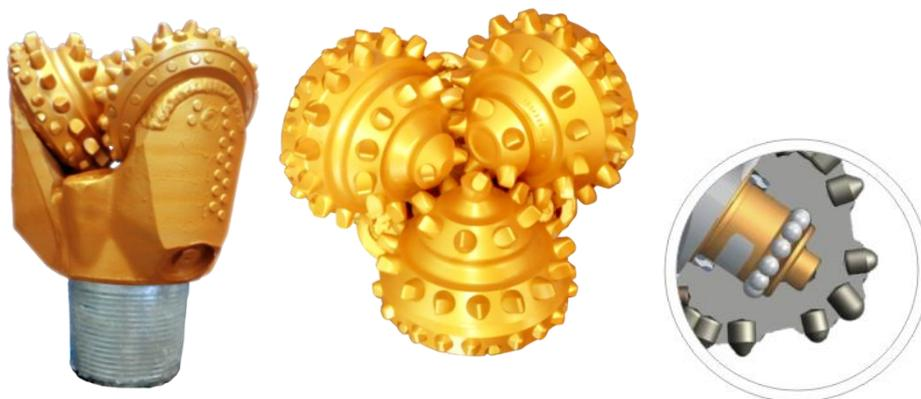
SHJ 系列钻头采用滑动轴承金属密封，适用于地热井高温钻井和井下动力钻具配合的高转速钻井工艺需求。
