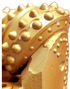
在掌尖径向敷焊 WC 耐磨材料，能有效延缓掌尖磨损，保护密封钻头的密封结构，延长钻头使用寿命。
